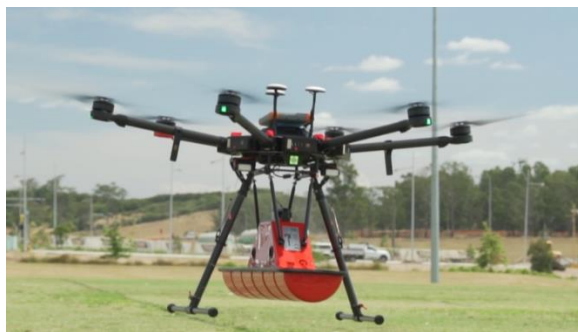
Фиг. 16. COBRA DJI Matrice 600 Pro с георадар ( GPR ) използва радиолокационния сигнал в реално време
