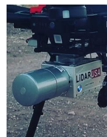
Лидарна камера Snoopy Lidar USA, заснема терена с 700 000 точки/s, има 32 индивидуални лазера с обхват - 40 градуса вертикален и 360 градуса хоризонтален, +/- 2 cm точност и 100 m обхват
